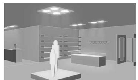
**Flächeneinbauleuchten, Lichtwände und Lichtdecken** produzieren diffuses bis gering gerichtetes Licht und eignen sich insbesondere für die indirekte Beleuchtung.
