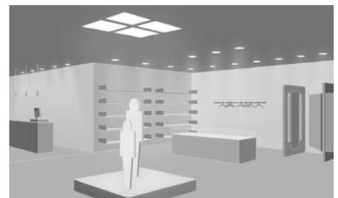
Eine **dreh-/schwenkbare** Ausführung von **Einbauleuchten** erlaubt es – zum Beispiel in Ausstellungsräumen – die Strahler beliebig auszurichten. Über Stellmotoren können sie bewegt und fokussiert werden.
