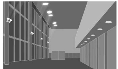
**Voutenleuchten:** Vouten sind rinnenförmig z.T. stukkatierte Ausbildungen in oder an Decken oder Wänden für eine indirekte Raumbeleuchtung. Leuchtmittel: Leuchtstofflampen oder LED.
